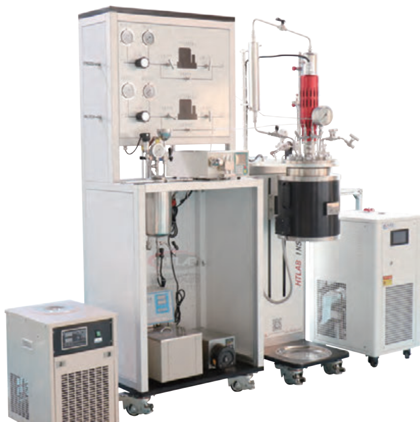
半连续气-液反应动力学研究装置
